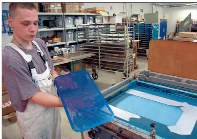
Dieser Mitarbeiter zeigt den Druck eines Resist als Vorstufe für eine partielle Schwarzverchromung.
