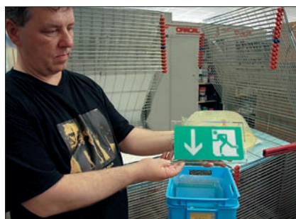
Folgen Sie dem Pfeil: Beidseitiger, staubfreier Druck auf Acrylglaszuschnitten.
