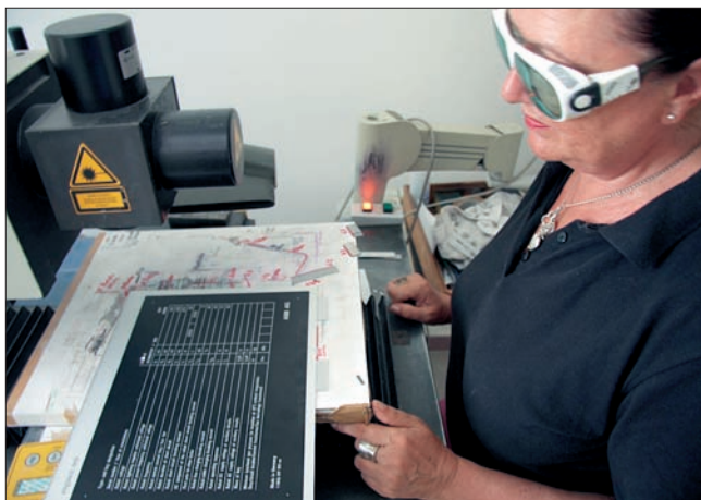
Nur mit Schutzbrille: Laserung der Variablen in ein Untereloxaldruckschild durch eine Mitarbeiterin der Weidling GmbH.
