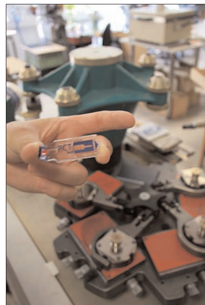
Hoch deckender zweifarbiger Tampondruck auf Kleinteilen für die Medizintechnik
