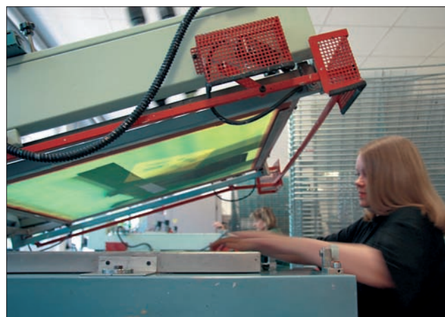
Präzision gefragt: Druck von Folientastaturen an einem Halbautomat mit Winkelöffnung erfordert höchste Genauigkeit.
